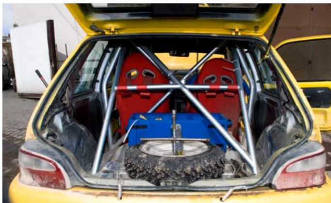
▲ В САЛОНЕ - каркас, запаска и каркас безопасности.
